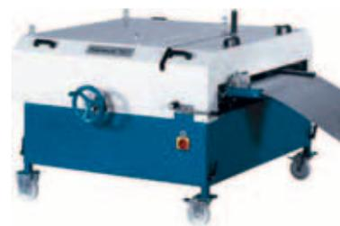
Equipaggiamento: Taglierina trasversale manuale a rulli - Taglierina longitudinale - Contometri con arresto avanzamento al raggiungimento della lunghezza impostata - Larghezza x Lunghezza = 1370x1600 mm; Altezza variabile da 850-1050 mm - Peso ca. 315 kg - Velocità 11 mt/min - Alimentazione: 220 volt monofase - Consumo 1,1 kw
