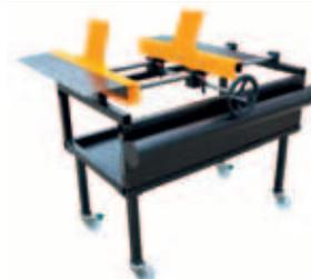
Grazie a questa macchina un operatore da solo è in grado di assemblare una convesa in minor tempo e con un'ottima qualità di finitura - Campo di applicazione 200-1300 mm - Piastre comprese 35° e 45° - Peso 180 kg
