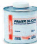
Prespalmatura con resina silossanica in solvente. Per primarizzazione dei fianchi del giunto soggetti a forte stress o dove l'adesione può risultare difficile prima dell'applicazione di sigillanti siliconici. Consumo: ca. 300 ml/mq.
